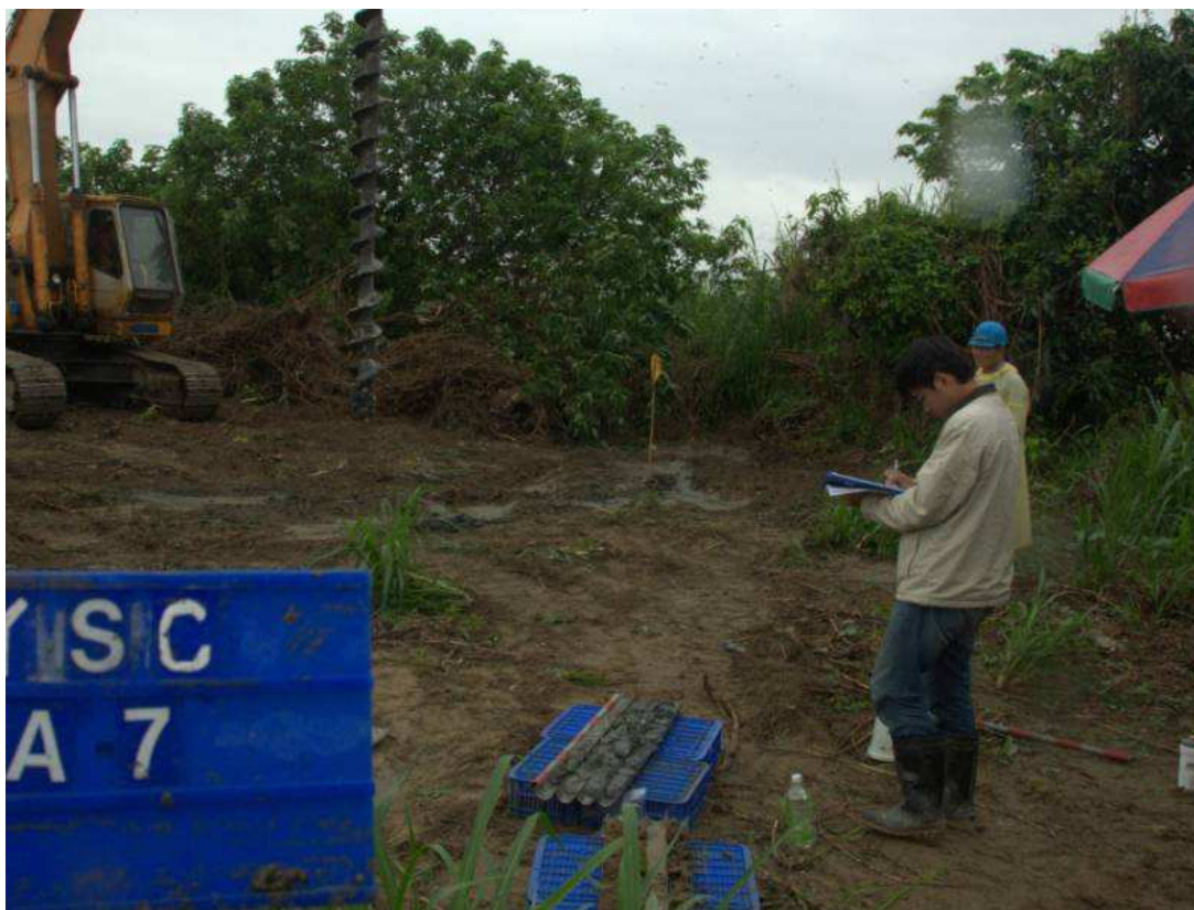
圖版 11：螺旋鑽孔現場土樣記錄工作
