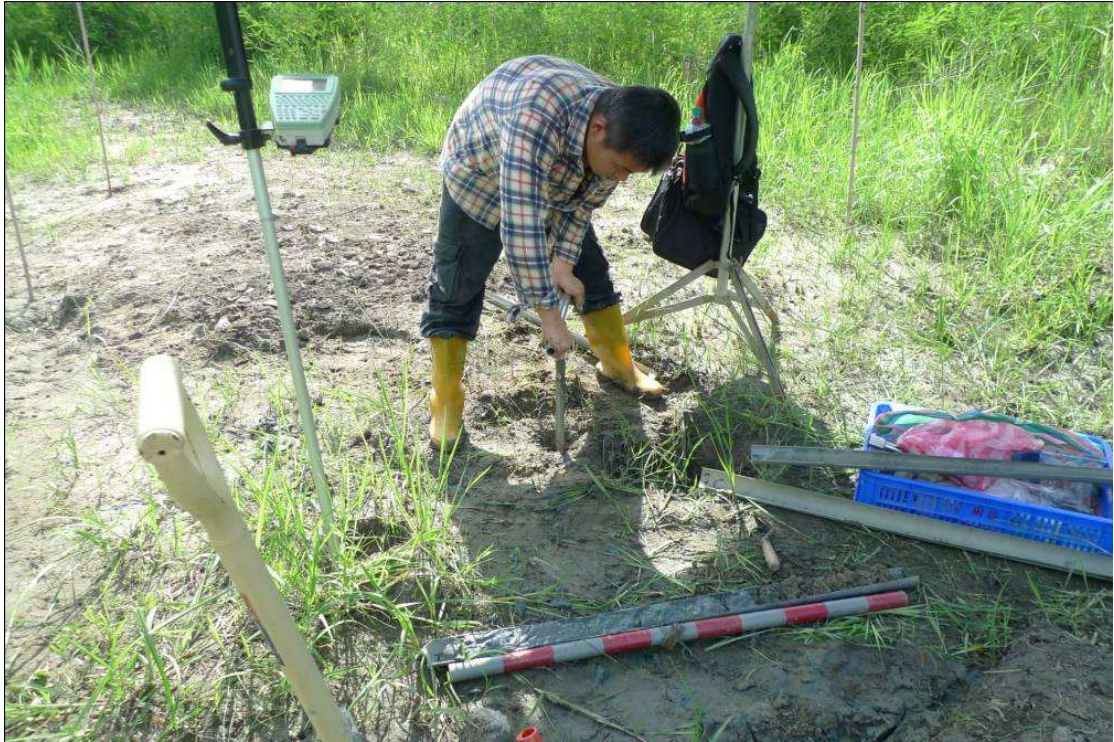
圖版 9：人工採土器取樣工作狀況
