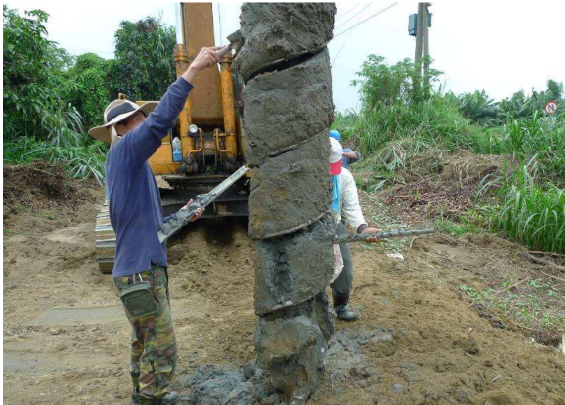
圖版 8：螺旋鑽探過程中依序由深至淺將土樣置於半塑膠管
